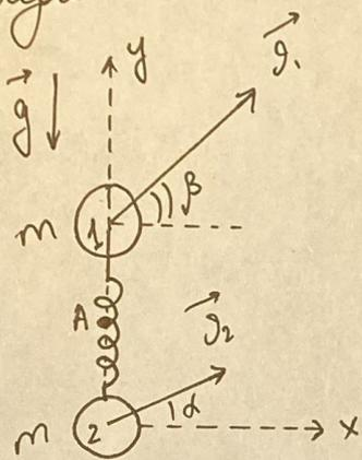
Если  $\vartheta_1 \sin \beta > \vartheta_2 \sin \beta$ , то пружина вначале будет растягиваться. В таком случае будет действовать на шар сила, направленная к середине пружины.
