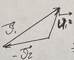
$v_{12}$  - скорость шара 1 в со шара 2.
