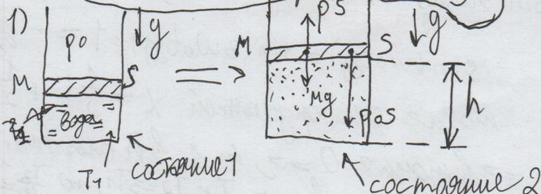
Предположим, что после нагрева поршня на высоту  $h$  и нагрева конструкции до температуры  $T_2 = 400 \text{ К}$ , вся вода перешла в паробразное состояние. Тогда давление  $p^*$  под поршнем равно  $p^*$ .
