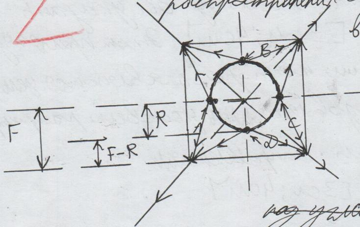
в данном граничном случае свет, выходящий из любой из директивных точек (A, B, C, D) и идущий в край линзы, выходит из линзы под углом  $45^\circ$  к диагонали системы (см. рисунок)
