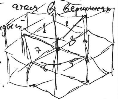
Маленькие шары, соответствующие водороду, полностью принадлежат своей эл. ячейке и содержатся в ней в количестве 8-ми штук  $\rightarrow$  на одну эл. яг. приходится 4 атома V и 8 атомов H  $\rightarrow$  в-во соответствует формуле  $V_4H_8$ , или, вернее,  $VH_2$ .
