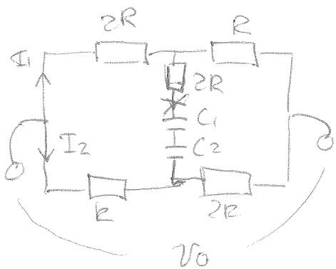
тк когда конденсатор зарядится, через него не будет тока т.о напряжение на последовательных подключенных к конденсатору резисторах не будет.
