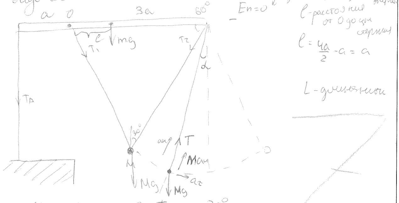
$$Mg = T_1 \cdot \cos 30^\circ + T_2 \cdot \cos 30^\circ$$
