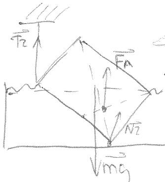
$m_g$  приложена в центре масс детали в этом сечении на пересечении диагоналей треугольника. Диагональ треугольника а. в детали параллельно.
