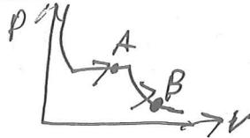
После погружения в воду начальное давление в трубке равно  $P_1 = P_{\text{нач}} + P_0$  по закону Паскаля.
