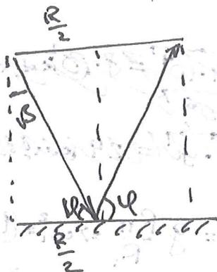
Угол падения луча на зеркало равен углу отражения.
