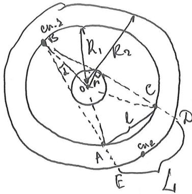
находясь в области  $L$ , спутники оказываются в "слепой" зоне, где  $L$ - участок орбиты зона спутника, заключающейся между касательными от спутника к  $L$  к Земле. Далее  $L$ - зона этого участка.
