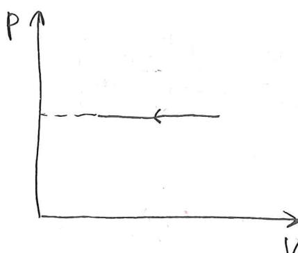
график  $p-V$  для насыщенных водяного пара при сжатии с постоянной температурой
