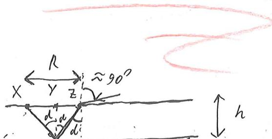
дальше угол преломления, чем дальние угол падения на зеркало, чем дальний угол отражения от зеркала (+ дальний падение на зеркало), чем дальние углы отражения. Падающие отраженные лучи падают в точку под углом  $\approx 90^\circ$  по закону Брэгга ( $n \sin d = 1 \cdot \sin 90^\circ$ ) преломленные под углом  $d$ :  $\sin d = \frac{1}{n}$ . Тогда эти лучи отражаются от зеркала и будут изогнуты на расстоянии  $R$  от зеркала (преломленные лучи будут падать на расстоянии от зеркала).
