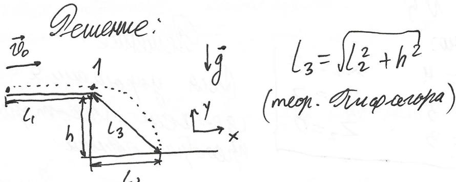
$$l_2 = v_0 \cdot t_1 \quad v_0 - \text{скорость бруска в точке 1}$$
