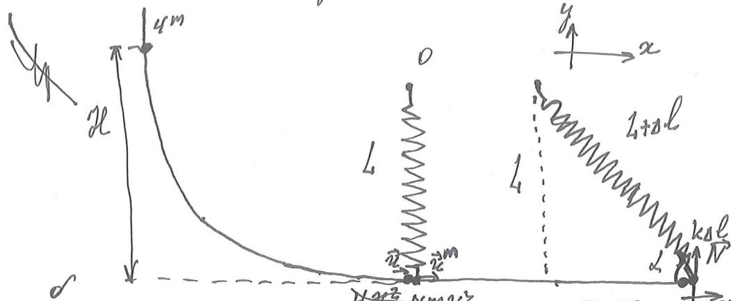
$$\text{ЗС для пружинки ЧМ: } 4mg\frac{h}{2} = \frac{4m\omega^2}{2} \Rightarrow \omega = \sqrt{2g\frac{h}{L}}$$
