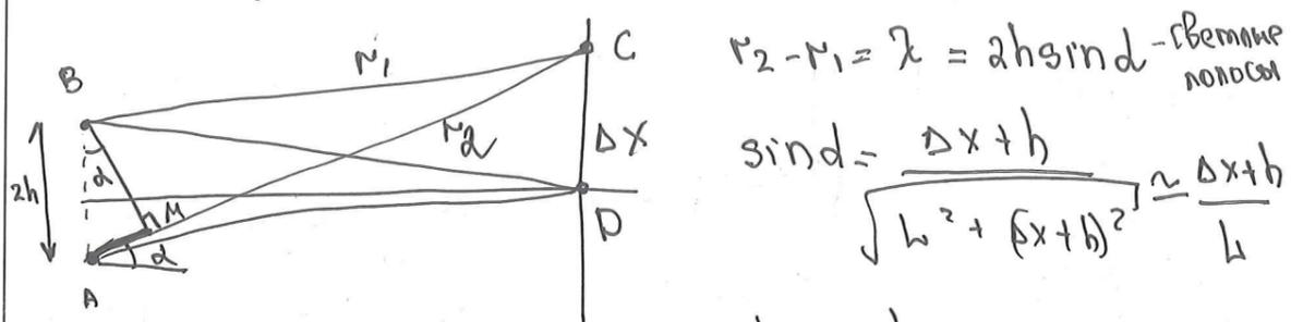
$r_2 - r_1 = \lambda = 2hsin\alpha$  - светлые полосы
