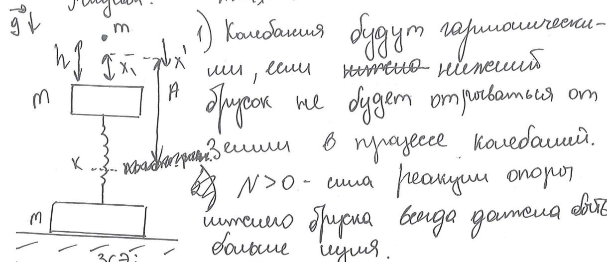
2)  $mgh = \frac{mv^2}{2} \Rightarrow v = \sqrt{2gh}$  - скорость шарика при подъёме к верхнему бруску.
