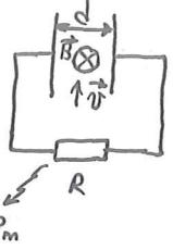
$$\mathcal{E}_i = \frac{d\Phi}{dt} \quad \Phi = B \cdot d \cdot \ell \quad \Rightarrow \quad U = B \cdot d \cdot \frac{d\ell}{dt} = B \cdot d \cdot V \quad (1)$$
