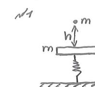
$$\begin{aligned} \text{Положение равновесия: } mg &= kx_0 \Rightarrow x_0 = \frac{mg}{k} \\ mg h &= \frac{m\Gamma^2}{2} \Rightarrow \Gamma = \sqrt{2gh} \end{aligned}$$
