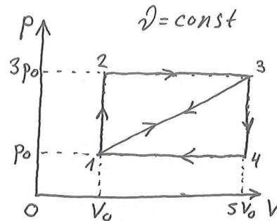
$$\begin{cases} \text{Ур-ние Клапейрона - Менделеева} \\ P_0 V_0 = 2RT_1 \\ 3P_0 V_0 = 2RT_2 \\ 15P_0 V_0 = 2RT_3 \\ 5P_0 V_0 = 2RT_4 \end{cases} \quad (1)$$
