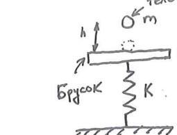
$$\begin{aligned} \text{тело: } mg h &\pm \frac{m\omega^2}{2} \Rightarrow \omega = \sqrt{2gh} \\ \text{после склеивания: } 2m\omega_0 &= m\omega \Rightarrow \omega_0 = \frac{\omega}{2} \end{aligned}$$
