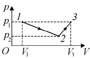
**Задача.** Давление некоторого количества идеального одноатомного газа медленно изменяют от величины  $p_1 = 2 \cdot 10^5$  Па до  $p_2 = 10^5$  Па, а затем вновь делают равным  $p_1$  в соответствии с  $pV$ -диаграммой, показанной на рисунке. Определите количество теплоты, которым газ обменялся с другими телами, если в исходном состоянии 1 его объём был равен  $V_1 = 10$  л, а в конечном состоянии 3 стал равным  $V_3 = 20$  л.
