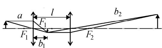
$\frac{1}{a} + \frac{1}{b_1} = \frac{1}{F_1}$  следует, что увеличение, даваемое первой линзой,  $\Gamma_1 = \frac{b_1}{a} = \frac{F_1}{a - F_1}$ . Для второй линзы можно
