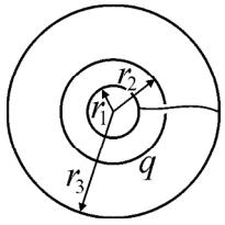
**Задача.** Три тонкие проводящие концентрические сферы первоначально не заряжены, а первая и третья сферы соединены между собой тонким изолированным проводом, проходящим через малое отверстие во второй сфере. Радиусы сфер  $r_1 = R$ ,  $r_2 = 2R$ ,  $r_3 = 4R$ . Какой заряд  $q_1$  будет наведен на сфере радиуса  $r_1$ , если сообщить средней сфере заряд  $q = 6$  нКл? Ответ выразите в нанокулонах, округлив до десятых.
