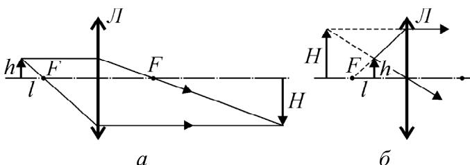
$$\Delta H = F \cdot \Delta h / l = 5 \text{ см.} \quad \text{Ответ: } \Delta H = F \cdot \Delta h / l = 5 \text{ см.}$$
