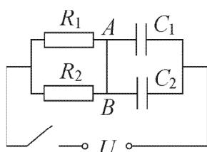
**4.** Два резистора сопротивлениями  $R_1 = 100$  Ом и  $R_2 = 200$  Ом и два конденсатора емкостями  $C_1 = 1$  мкФ и  $C_2 = 2$  мкФ подключены к источнику постоянного напряжения  $U = \text{В}$ , как показано на рисунке. Какой заряд  $\Delta q$  протечет через проводник  $AB$  за достаточно большой промежуток времени после замыкания ключа, если конденсаторы были первоначально разряжены? Ответ приведите в микрокулонах, округлив до целых.
