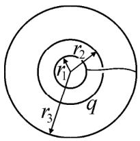
**Задача.** Три тонкие проводящие концентрические сферы первоначально не заряжены, а первая и третья сферы соединены между собой тонким изолированным проводом, проходящим через малое отверстие во второй сфере. Радиусы сфер  $r_1 = R$ ,  $r_2 = 2R$ ,  $r_3 = 4R$ . Какой заряд  $q$  сообщили средней сфере, если заряд, наведенный на сфере радиуса  $r_1$ , оказался равным  $q_1 = 3$  нКл? Ответ выразите в нанокулонах, округлив до десятых.
