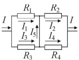
$I_2 R_2 = I_4 R_4$ . Из записанных равенств находим, что  $I_1 = I \frac{R_3}{R_1 + R_3}$ ,  $I_2 = I \frac{R_4}{R_2 + R_4}$  и  $I_5 = I_2 - I_1 = I \cdot \frac{R_1 R_4 - R_2 R_3}{(R_1 + R_3)(R_2 + R_4)}$ . По условию  $\frac{I}{I_5} = n$ , откуда
