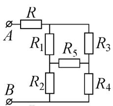
**3.** В цепи, схема которой показана на рисунке, сопротивление резистора  $R = 500$  Ом, а между клеммами  $A$  и  $B$  поддерживается постоянное напряжение  $U = 20$  В. Определите количество теплоты  $Q$ , выделяющееся на этом резисторе за время  $\tau = 5$  минут, если сопротивления остальных резисторов  $R_1 = 2R$ ,  $R_2 = 4R$ ,  $R_3 = R$ ,  $R_4 = 2R$ ,  $R_5 = R$ . Ответ приведите в джоулях с точностью до одного знака после запятой.
