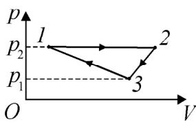
**Задача.** Над некоторым количеством гелия совершают циклический процесс,  $pV$ -диаграмма которого показана на рисунке. Определите коэффициент полезного действия  $\eta$  цикла, если температура гелия при переходе из состояния 3 в состояние 1 монотонно падает, а отношение давлений  $p_2 / p_1 = n = 2$ .
